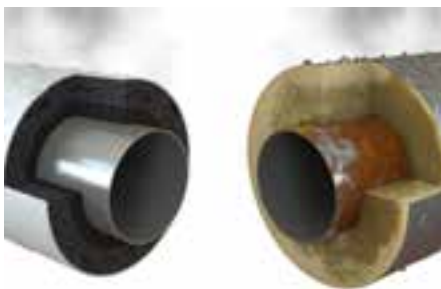
Som en uavhengig studie viser, så minimerer Armaflex cellegummiisolasjon risikoen for korrosjon under isoleringen. Isolasjonsmateriale med en åpen cellestruktur er på den andre siden ikke beskyttet mot fuktabsorpsjon og har dermed høyere CUI-risiko. Illustrasjon: Armaflex
